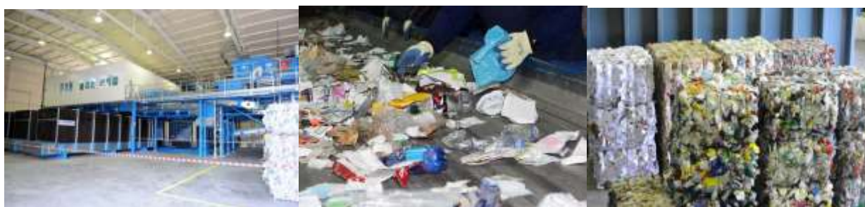
Εικόνα 3.2.1.4: Διαλογή στο ΚΔΑΥ, και συμπύεση-δεματοποίηση αποβλήτων συσκευασιών
